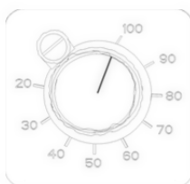
Fig. 9.2 Réglage de la capacité de dosage (mécanique)
