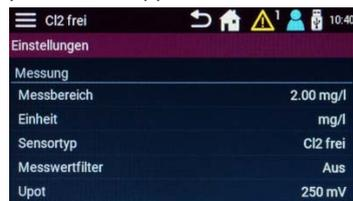
Je nach gewählter Messung werden unterschiedliche Parametereinstellungen angezeigt. Auf- bzw. Abschieben ist jederzeit möglich, sofern weitere Parameter vorhanden sind (je nach Messwert).
