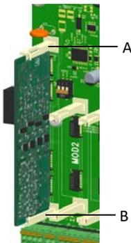
Abb. 19 Ansicht Einbau der 4-fach mA-Ausgangskarte
