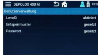
Der Parameter Level 1, 2 oder 3 wird verwendet, um den Bedienlevel 1, 2 und 3 zu aktivieren oder zu deaktivieren. Um den Level zu verwenden, ist die Einstellung „aktiviert“ einzugeben. Nach Aktivierung ist es erforderlich ein Entsperrmuster und bzw. ein Passwort zum Login zu definieren (mindestens einer der beiden Login-Möglichkeiten muss gesetzt werden).
