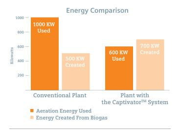
THE CAPTIVATOR™ SYSTEM CHANGES AN ANAEROBIC PLANT'S ENERGY BALANCE.
